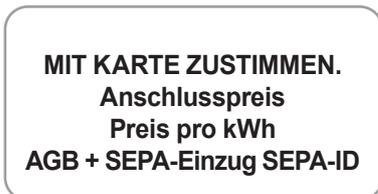
Tarifinformationen zum Ladevorgang werden im Display angezeigt und müssen nochmal durch Vorhalten der Giro-Karte bestätigt werden. Die SEPA-ID ist als Authentifizierungsfaktor im signierten Datenpaket enthalten. Zur Überprüfung, ob das Datenpaket richtig zugeordnet wurde, muss die angezeigte ID mit der in der Transparenzsoftware abgeglichen werden.
