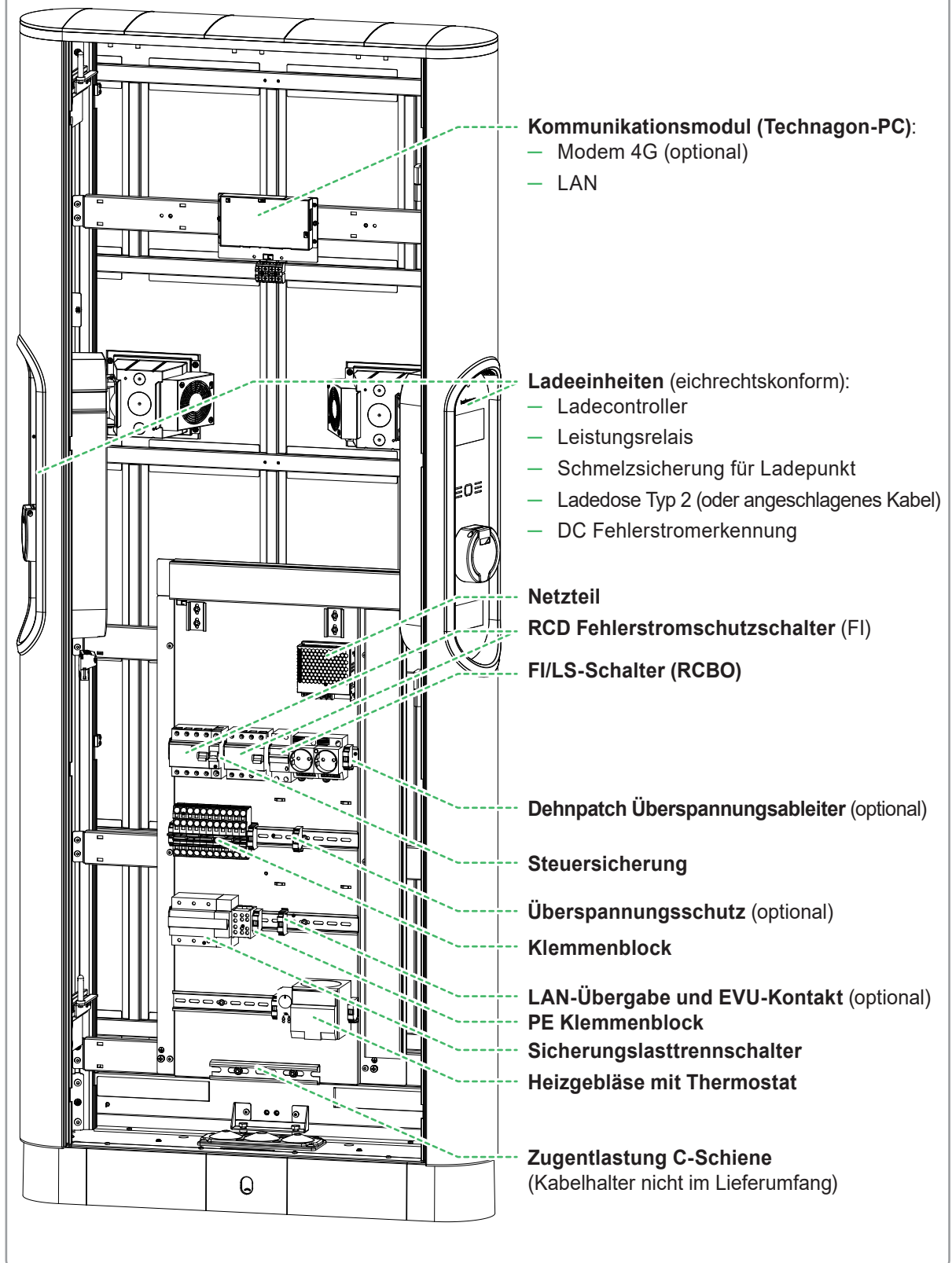
Abbildung 6: Aufbau TEP8 innen
