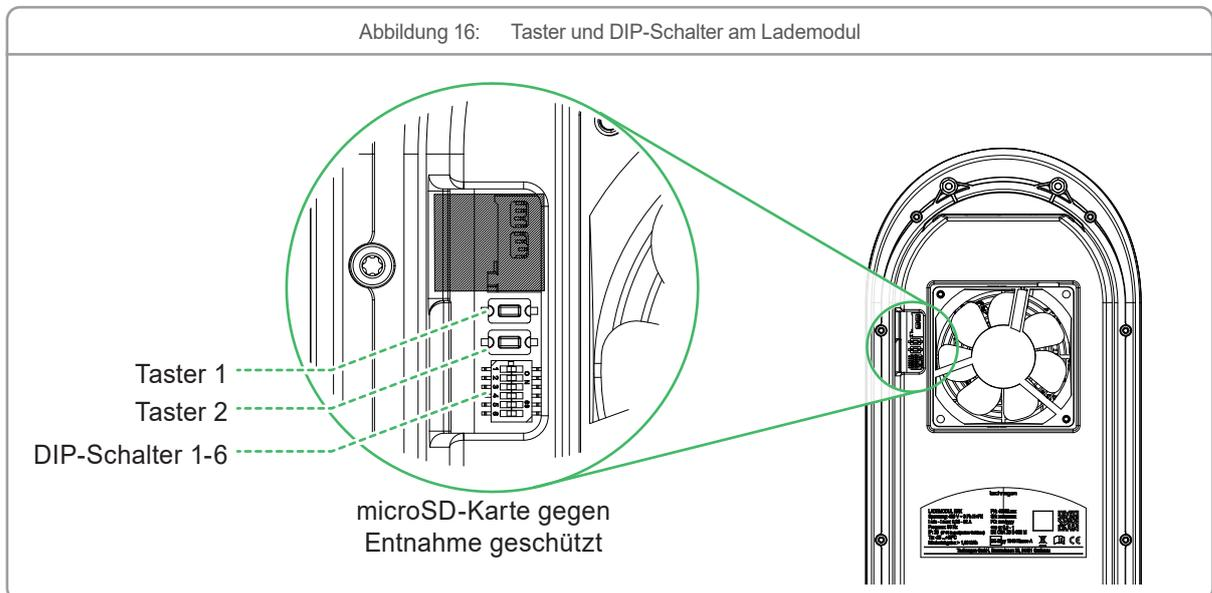
Unterhalb des microSD-Karten-Slots befinden sich folgende Taster und DIP-Schalter:
