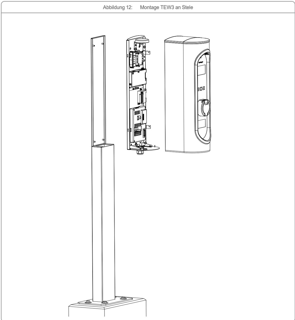
1. Zuerst alle Kabel durch die Stele führen und die Stele dann auf das Fundament stellen.
