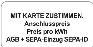
Tarifinformationen zum Ladevorgang werden im Display angezeigt und müssen nochmal durch Vorhalten der Giro-Karte bestätigt werden. Die SEPA-ID ist als Authentifizierungsfaktor im signierten Datenpaket enthalten. Zur Überprüfung, ob das Datenpaket richtig zugeordnet wurde, muss die angezeigte ID mit der in der Transparenzsoftware abgeglichen werden.
