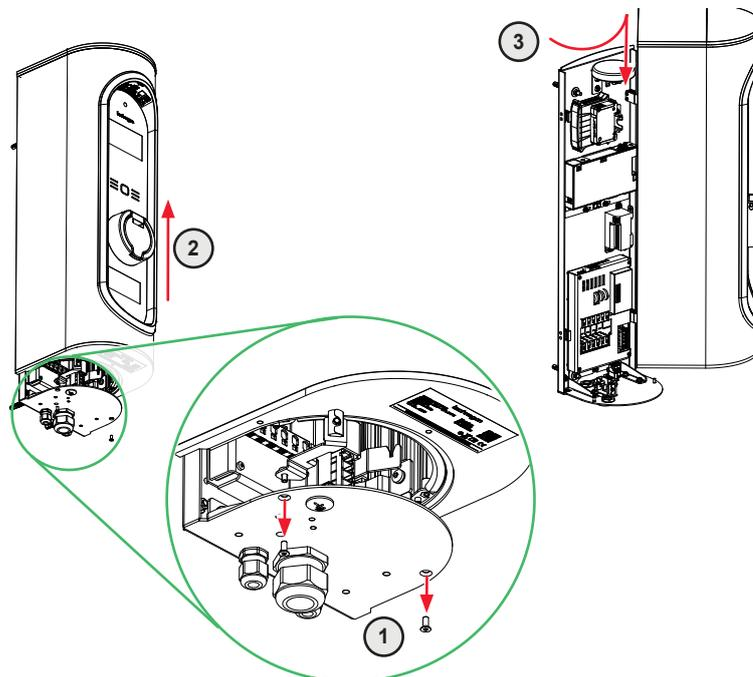
1. Die beiden Sicherheitsschrauben auf der Gehäuseunterseite mit einem TORX BO Schraubendreher entfernen.
